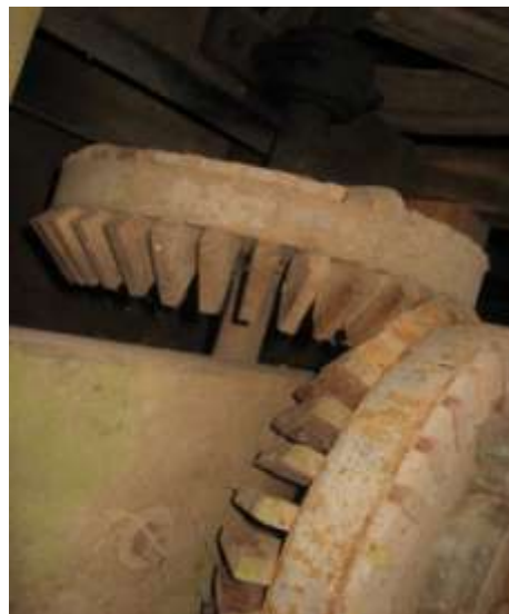
Fig. 06: Engrenagem de madeira
