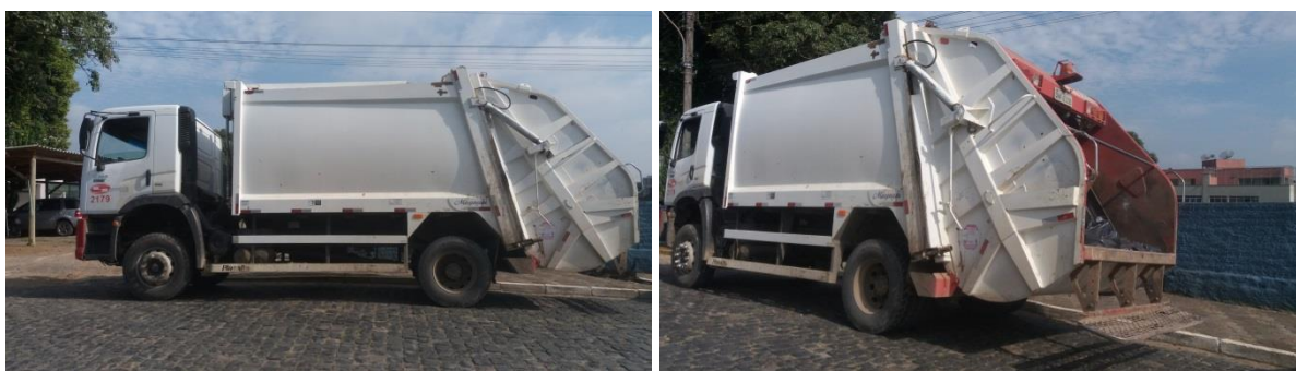
Figura 8: Caminhão coletor compactador – Empresa Serrana.
